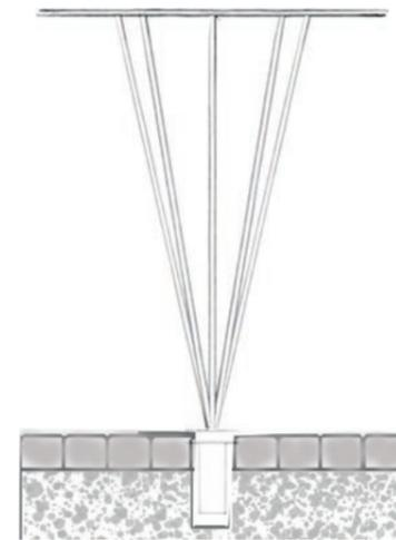
Ganz nach Calatrava werden die Tische aus leichtem Stahl gefertigt. Sie werden wie Sonnenschirme in den Boden eingesetzt und sind daher sehr mobil. Die Haltesockel werden bündig anstelle eines einzelnen Pflastersteines eingesetzt. Das verleiht dem Tisch Stabilität auf den Pflastersteinen. Es werden Stehtische 105cm und Bistrotische 74cm sowie Sitzmöbel der Firma Stol eingesetzt. Diese bestehen aus einem schlichten Stahlrohrgestell und farbigen hölzernen Sitzflächen.
